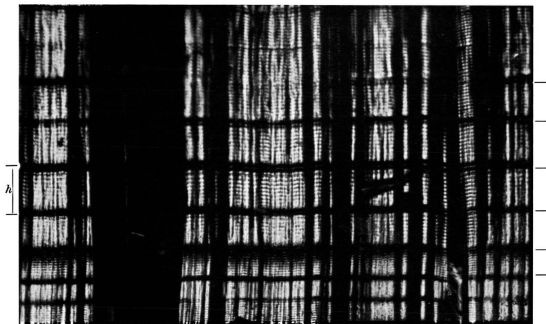
Abb. 4. Bruchfront. Mikroskopische Vergr. 1:150. h = 40 \mu . Striche weisen auf die Pausen zwischen den Bedampfungen hin.
